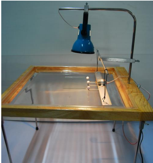
ภาพที่ 13 ขอบแผ่นกระจกใสขนานกับแผ่นกำเนิดคลื่น
