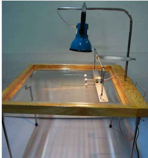
ขอบแผ่นกระจกใสขนานกับแผ่นกำเนิดคลื่น
