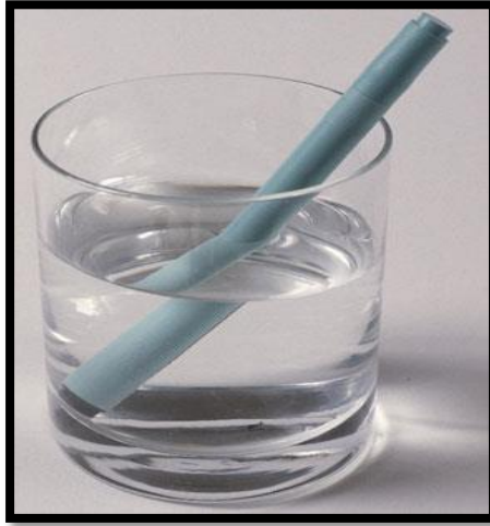
ภาพที่ 2 การหักเหของแสงจากอากาศเข้าสู่ตา
